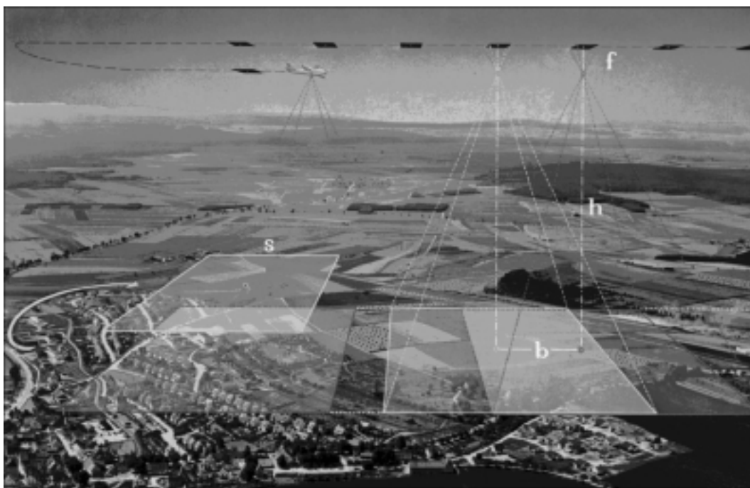
Figura V-1: Fotogrametría Aérea: vuelo y modelos estereoscópicos
