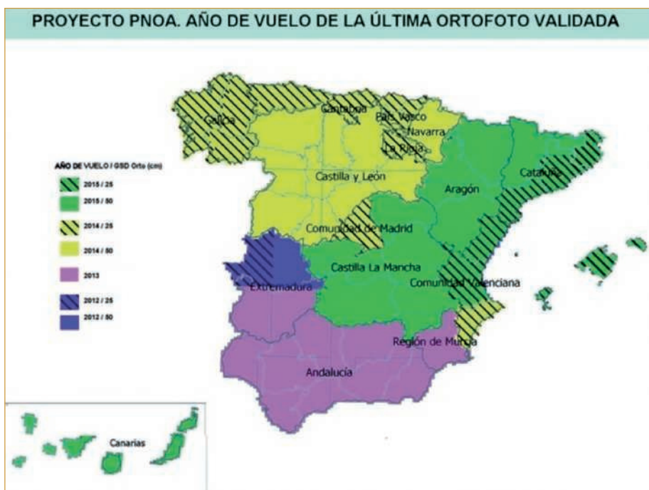
Figura 2. Especificaciones técnicas del proyecto PNOA. Años de vuelo y resoluciones de las ortofotos según las zonas. Fuente: IGN.
