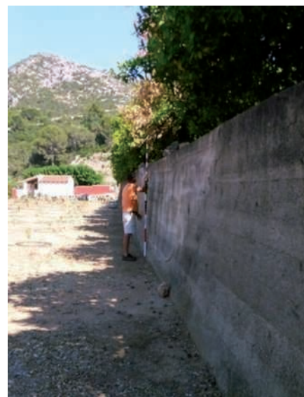
Figura 1. Levantamiento topográfico, medición de un muro con GPS. Fuente: propia.
